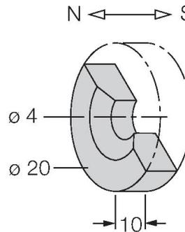
Активирующий магнит; Ø 20 мм (Ø 4 мм), h: 10 мм; достигаемая дистанция переключения 59 мм для датчиков магнитного поля BIM-(E)M12 и 50 мм для датчиков BIM-EG08; в комбинации с датчиками линейного перемещения Q25L: рекомендуемая дистанция между датчиком и магнитом: 3 ... 4 мм
