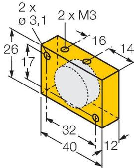
Актуатор, прямоугольный, пластиковый; достигаемая дистанция переключения 58 мм для датчиков магнитного поля BIM-(E)M12 и 49 мм для датчиков BIM-EG08; в комбинации с датчиками линейного перемещения Q25L: рекомендуемая дистанция между датчиком и магнитом: 3 ... 5 мм
