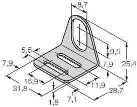
Монтажный кронштейн для цилиндрических резьбовых датчиков; материал: Нержавеющая сталь A2 1.4301 (AISI 304)
