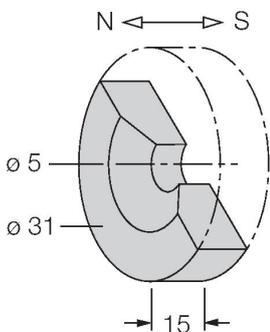
Магнит для активации Ø 31 мм (Ø 5 мм), h: 15 мм; достигаемая дистанция переключения 90 мм для датчиков магнитного поля BIM-(E)M12 и 78 мм для датчиков BIM-EG08; в комбинации с датчиками линейного перемещения Q25L: рекомендуемая дистанция между датчиком и магнитом: 3 ... 5 мм
