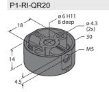
1593041 Позиционирующий элемент для энкодера RI-QR20, для валов Ø 6 мм
