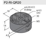
Позиционирующий элемент для энкодера RI-QR20, для валов Ø 6.35 мм
