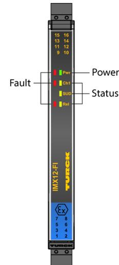
Le convertisseur de mesure de fréquence IMX12-FI01-1SF-1R-PR/24VDC/CC est équipé de circuits d'entrée à sécurité intrinsèque et transmet des signaux de fréquence jusqu'à 20 000 Hz séparés galvaniquement de la zone explosive à la zone sûre. L'appareil permet de surveiller des valeurs limites. L'appareil est destiné à une utilisation en zone 2.
