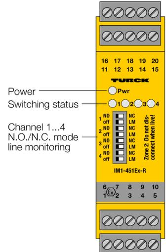
L'amplificateur séparateur à 4 canaux du type IM1-451EX-R est équipé de circuits d'entrée à sécurité intrinsèque.
