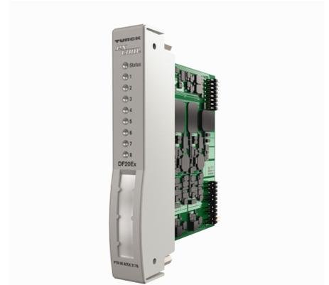
Le module d'entrée DF20EX est équipé de huit canaux suivant NAMUR, qui sont unis en deux blocs. Par bloc il y a une entrée de fréquence et trois entrées/sorties de commande.
