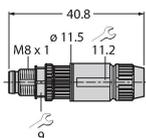
Connecteur mâle confectionnable, M8 x 1, droit, 4 pôles, raccordement par borne guillotine, diamètre de ligne 2.5 à 5.1 mm, section conducteur/section raccordable 0,14 à 0,34 mm<sup>2</sup>, boîtier plastique, écrou de montage métallique
