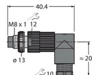
Connecteur mâle confectionnable, M8 x 1, coudé, 4 pôles, technique de pénétration, diamètre de ligne 4.0 à 5.0 mm, section conducteur/section raccordable 0,14 à 0,34 mm<sup>2</sup>, boîtier plastique, écrou de montage métallique
