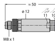
Connecteur mâle confectionnable, M8 x 1, droit, 4 pôles, raccordement par borne à vis, diamètre de ligne 3,5 à 5,0 mm, section conducteur/section raccordable 0,14 à 0,50 mm<sup>2</sup>, boîtier plastique, vis de montage métallique
