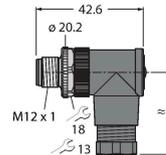
Connecteur confectionnable, M12 x 1, coudé, 4 broches, raccordement par borne à vis, diamètre de ligne de 4,0 à 6,0 mm, section conducteur/section raccordable de 0,14 à 0,75 mm<sup>2</sup>, boîtier plastique, vis de montage métallique
