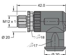
Connecteur mâle confectionnable, M12 x 1, coudé, 4 pôles, raccordement par borne à vis, diamètre de ligne 4.0 à 8.0 mm, section conducteur/section raccordable 0.25 à 1.5 mm<sup>2</sup>, boîtier plastique, vis de montage métallique
