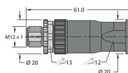
Connecteur mâle confectionnable, M12 x 1, droit, 4 pôles, raccordement par borne à vis, diamètre de ligne 4.0 à 8.0 mm, section conducteur/section raccordable 0,25 à 1.5 mm<sup>2</sup>, boîtier plastique, vis de montage métallique
