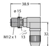
Connecteur mâle confectionnable, M12 x 1, coudé, 4 pôles, raccordement par borne guillotine, diamètre de ligne 4.0 à 5.1 mm, section conducteur/section raccordable 0,14 à 0.34 mm<sup>2</sup>, boîtier plastique, écrou de montage métallique
