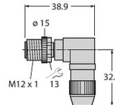
Connecteur mâle confectionnable, M12 x 1, coudé, 4 pôles, raccordement par borne guillotine, diamètre de ligne 4.0 à 5.1 mm, section conducteur/section raccordable 0,14 à 0.34 mm<sup>2</sup>, boîtier plastique, écrou de montage métallique
