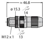
Connecteur mâle confectionnable, M12 x 1, droit, 4 pôles, raccordement par borne guillotine, diamètre de ligne 4.0 à 5.1 mm, section conducteur/section raccordable 0,14 à 0.34 mm<sup>2</sup>, boîtier plastique, écrou de montage métallique
