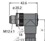
Connecteur confectionnable, M12 x 1, coudé, 4 broches, raccordement par borne à vis, diamètre de ligne de 4,0 à 6,0 mm, section conducteur/section raccordable de 0,14 à 0,75 mm<sup>2</sup>, boîtier plastique, vis de montage métallique
