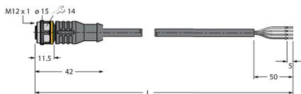
Câble de raccordement, connecteur femelle M12, droit, 4 broches, longueur de câble : 2 m, matériau de la gaine : PVC, bleu ; homologation cULus
