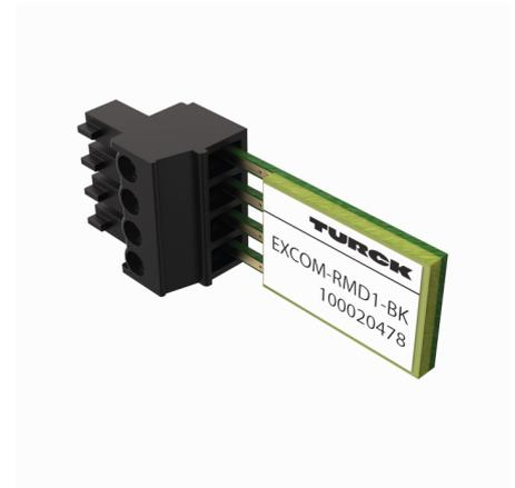
L'excom-RMD1-BK est utilisé pour supprimer les messages de diagnostic des modules d'entrée excom dans une zone potentiellement non explosive. Pour les entrées numériques, le message de rupture de câble et de court-circuit est évité. Pour les entrées analogiques, les messages supplémentaires de dépassement inférieur et supérieur. Le module peut être utilisé sur les modules d'entrée suivants :
