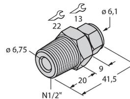
Accesorio de compresión para el montaje directo de los sensores de temperatura; diámetro del sensor de 6 mm; conexión del proceso con rosca macho NPT de 1/2"
