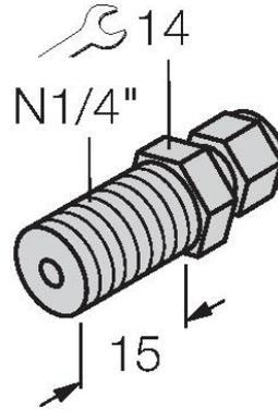
Accesorio de compresión para el montaje directo de los sensores de temperatura; diámetro del sensor de 6 mm; conexión del proceso con rosca macho NPT de 1/4"
