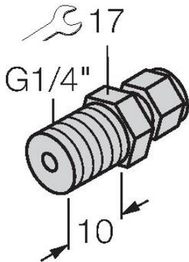
Accesorio de compresión para el montaje directo de los sensores de temperatura; diámetro del sensor de 6 mm; conexión del proceso con rosca macho G1/4"
