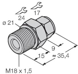
Accesorio de compresión para el montaje directo de los sensores de temperatura; diámetro del sensor de 6 mm; conexión del proceso con rosca macho M18 x 1
