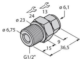
Accesorio de compresión para el montaje directo de los sensores de temperatura; diámetro del sensor de 6 mm; conexión del proceso con rosca macho G1/2"
