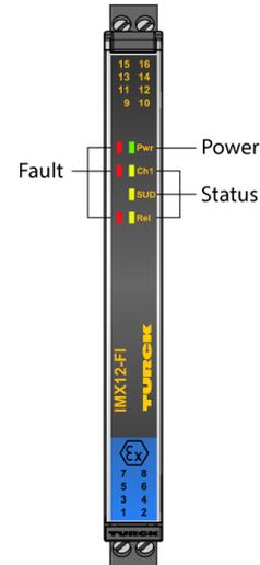
El transductor de frecuencia IMX12-FI01-1SF-1R-0/24 V CC está equipado con circuitos de entrada intrínsecamente seguros y emite una transmisión aislada galvánicamente de señales de frecuencia de hasta 20 000 Hz desde el área con peligro de explosiones al área segura. Este dispositivo se utiliza para supervisar los valores límite. El dispositivo es adecuado para su uso en Zona 2.
