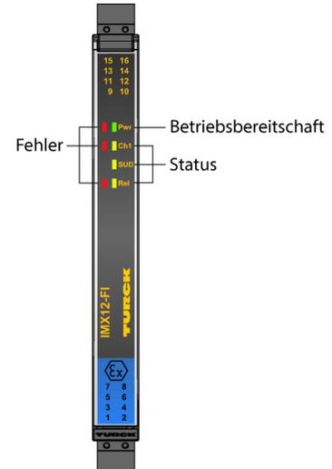
Der Frequenzmessumformer IMX12-FI01-1SF-1R-PR/24VDC/CC ist mit eigensicheren Eingangskreisen ausgestattet und überträgt Frequenzsignale bis 20000 Hz galvanisch getrennt aus dem explosionsgefährdeten Bereich in den sicheren Bereich. Mit dem Gerät können Grenzwerte überwacht werden. Das Gerät ist für den Betrieb in Zone 2 geeignet.
