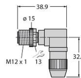
Konfektionierbarer Stecker, M12 x 1, gewinkelt, 4-polig, Schneidklemmanschluss, Leitungsdurchlass 4.0 bis 5.1 mm, Adernquerschnitt/Klemmvermögen 0.14 bis 0.34 mm<sup>2</sup>, Kunststoffgehäuse, Metallüberwurfmutter
