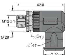
Konfektionierbarer Stecker, M12 x 1, gewinkelt, 4-polig, Schraubklemmanschluss, Leitungsdurchlass 4.0 bis 8.0 mm, Adernquerschnitt/Klemmvermögen 0.25 bis 1.5 mm<sup>2</sup>, Kunststoffgehäuse, Metallüberwurfschraube
