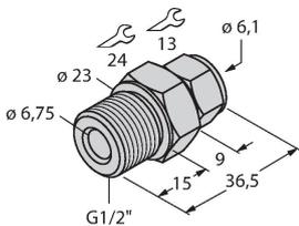
用于直接安装温度传感器的压紧接头；传感器直径6 mm；过程连接件 G1/2"外螺纹
