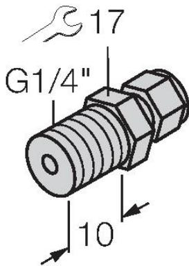
用于直接安装温度传感器的压紧接头；传感器直径6 mm；过程连接件 G1/4"外螺纹
