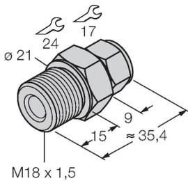
用于直接安装温度传感器的压紧接头；传感器直径6 mm；过程连接件 M18 x 1外螺纹
