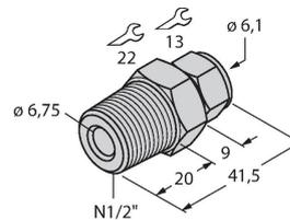
用于直接安装温度传感器的压紧接头；传感器直径6 mm；过程连接件 1/2" NPT外螺纹
