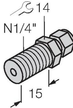
用于直接安装温度传感器的压紧接头；传感器直径6 mm；过程连接件 1/4" NPT外螺纹
