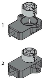
有两种不同的安装选择。一种选择是将定位元件置于传感器壳体上方。但是, 也可以在安装时使传感器壳体完全封闭定位元件。
