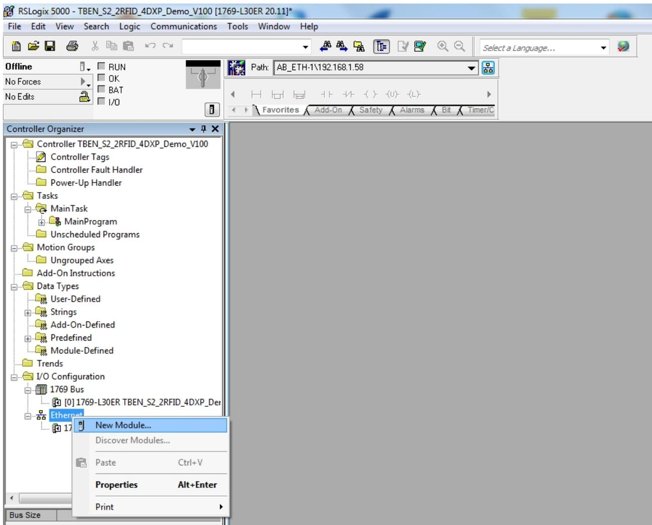
Fig. 51: Adding a new module
