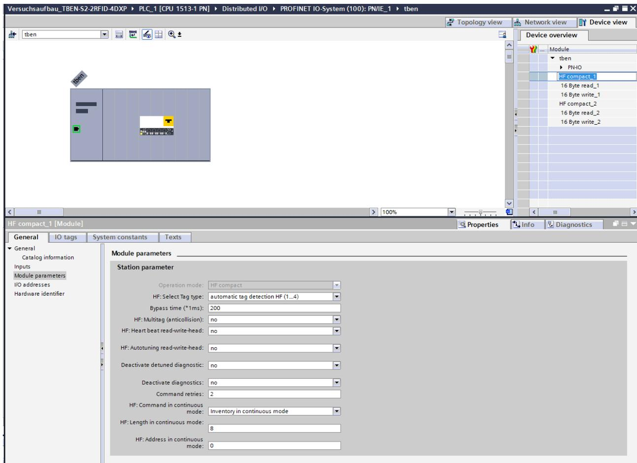
Fig. 72: Setting module parameters
