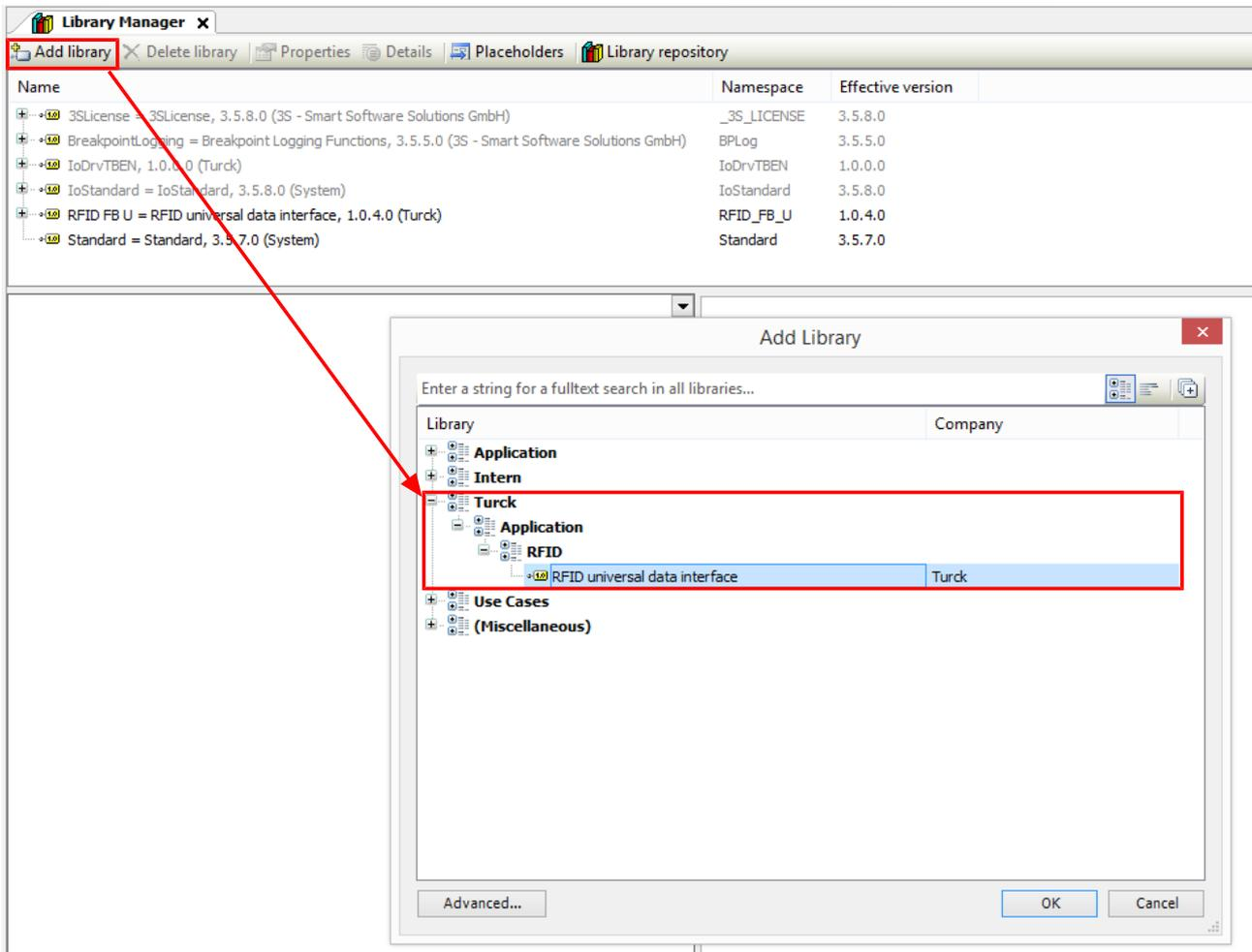
Fig. 143: Installing a CODESYS library
