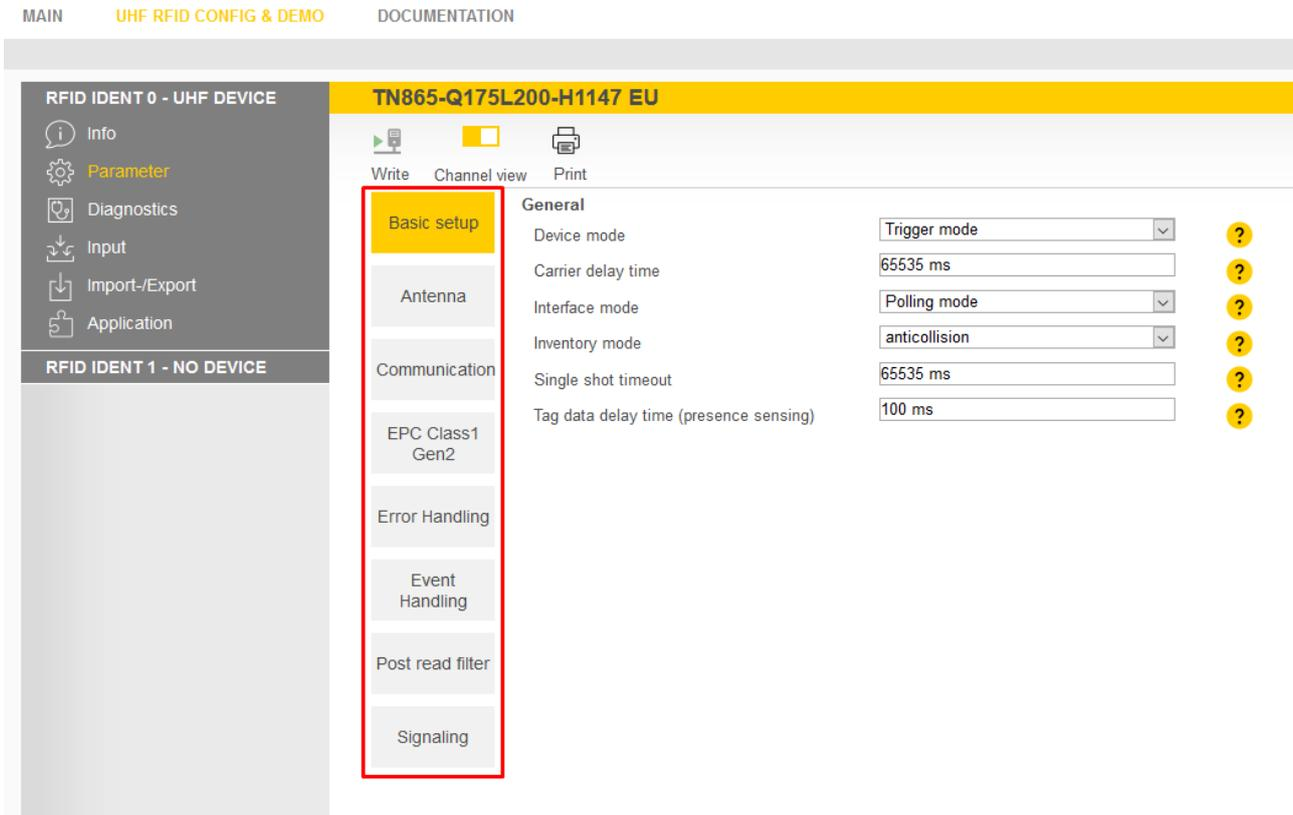
Fig. 121: Web server — UHF reader parameters
