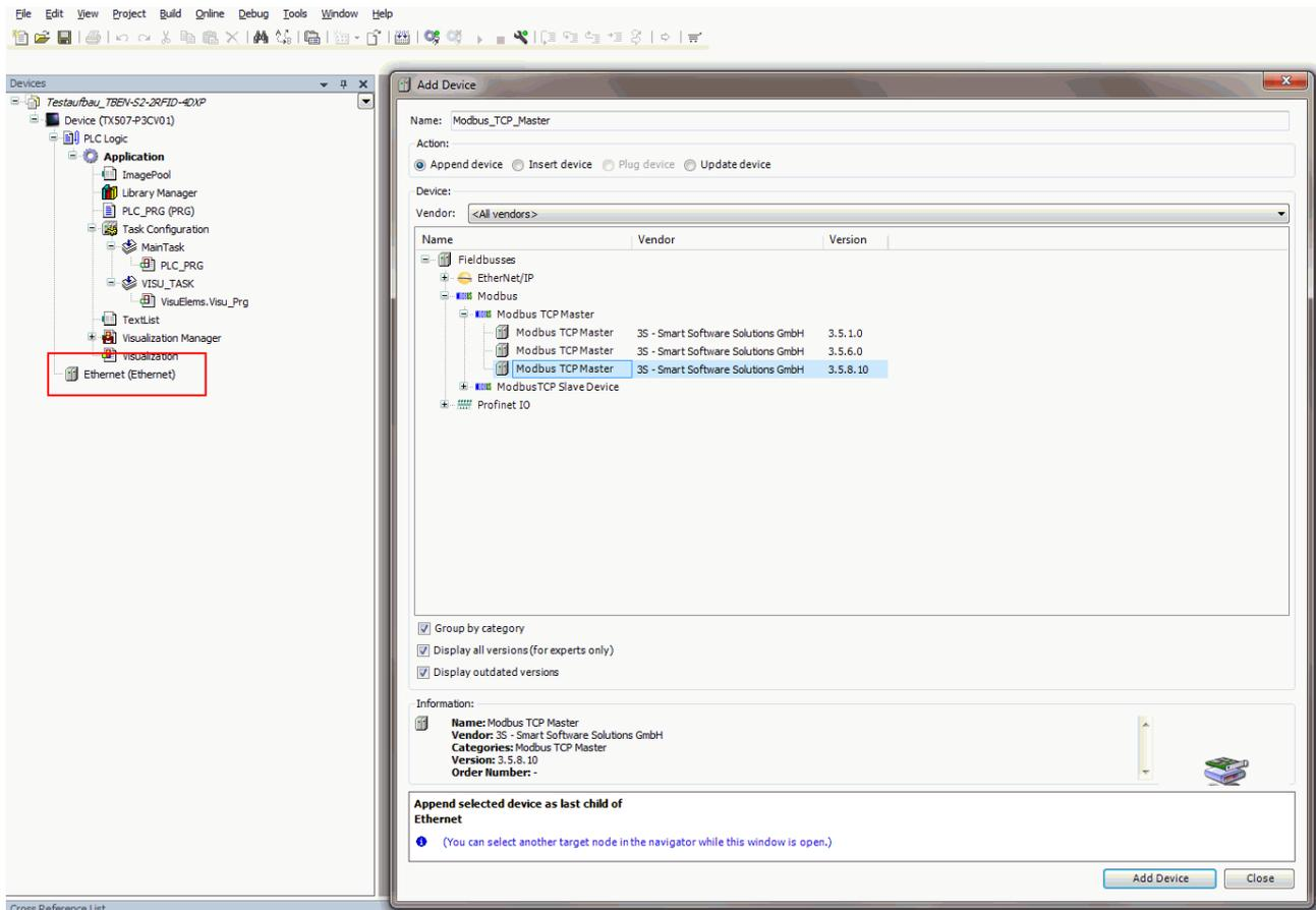
Fig. 37: Adding a Modbus master
