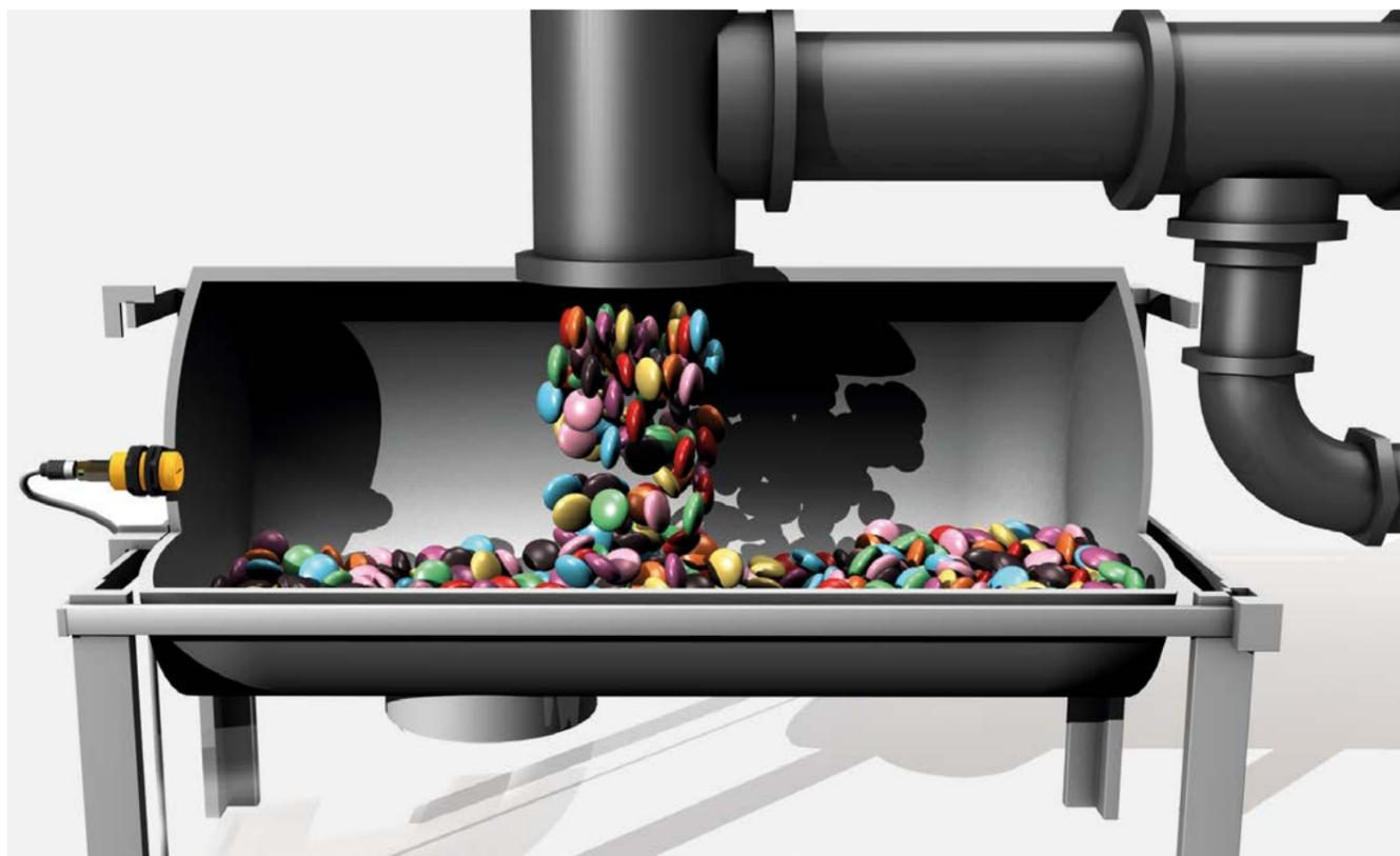
In der industriellen Automation erfassen kapazitive Sensoren diverse Medien und werden besonders häufig zur Füllstandüberwachung von Flüssigkeiten oder Schüttgütern eingesetzt. Ob in der Kunststoff-, Verpackungs-, Chemie-Industrie oder in mobilen Arbeitsmaschinen – Turcks BCT-Sensoren detektieren zuverlässig alle Feststoffe, Flüssigkeiten, Metalle und Nichtmetalle. Auch durch
