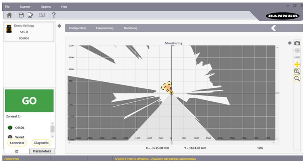
Abbildung 12. Darstellung des überwachten Bereichs durch die SX5soft-Software
