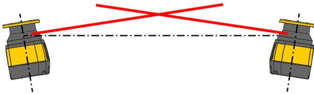
Abbildung 17. Mit unterschiedlichen Abtastwinkeln montierte Scanner
