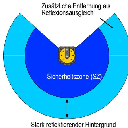
Abbildung 23. Stark reflektierenden Hintergrund reduzieren oder entfernen
