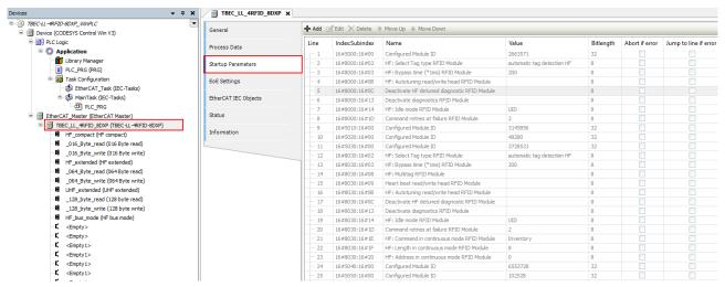
Fig. 61: Startup parameters of the module
