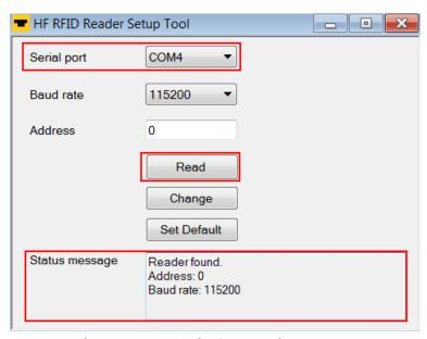
Fig. 90: Window – HF-RFID Reader Setup Tool
