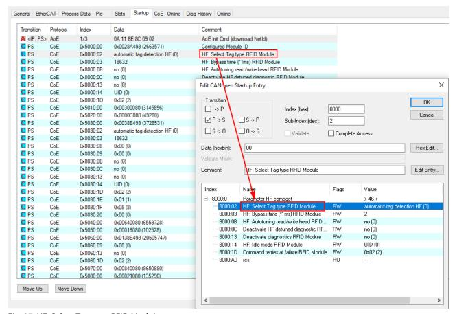
Fig. 37: HF: Select Tag type RFID Module
