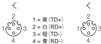
Ethernet通信用M12コネクタ
